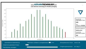
Der optionale Monitor mit integriertem Rechner zeigt die Ergebnisse der letzten Tests an. Ein Histogramm stellt die Verteilung der Ergebnisse dar und hilft Ihnen dabei zu erkennen, ob die Dichtigkeit der produzierten Verpackungen eine ungünstige Tendenz aufweist.
