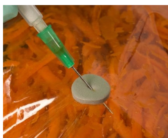
Septum perforé par une aiguille creuse.
