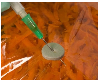
Septum perforé par une aiguille creuse.
